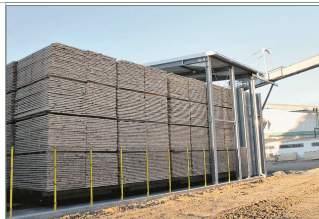
2018 bei Delco installierter Mühlböck-Kanaltrockner „Dynamic 1003 Premium“ mit einer jährlichen Trocknungskapazität von 100 Mio. Bft (rund 235 000 m 3 )
