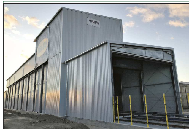
2018 bei Delco installierter Mühlböck-Kanaltrockner „Dynamic 1003 Premium“ mit einer jährlichen Trocknungskapazität von 100 Mio. Bft (rund 235 000 m 3 )
